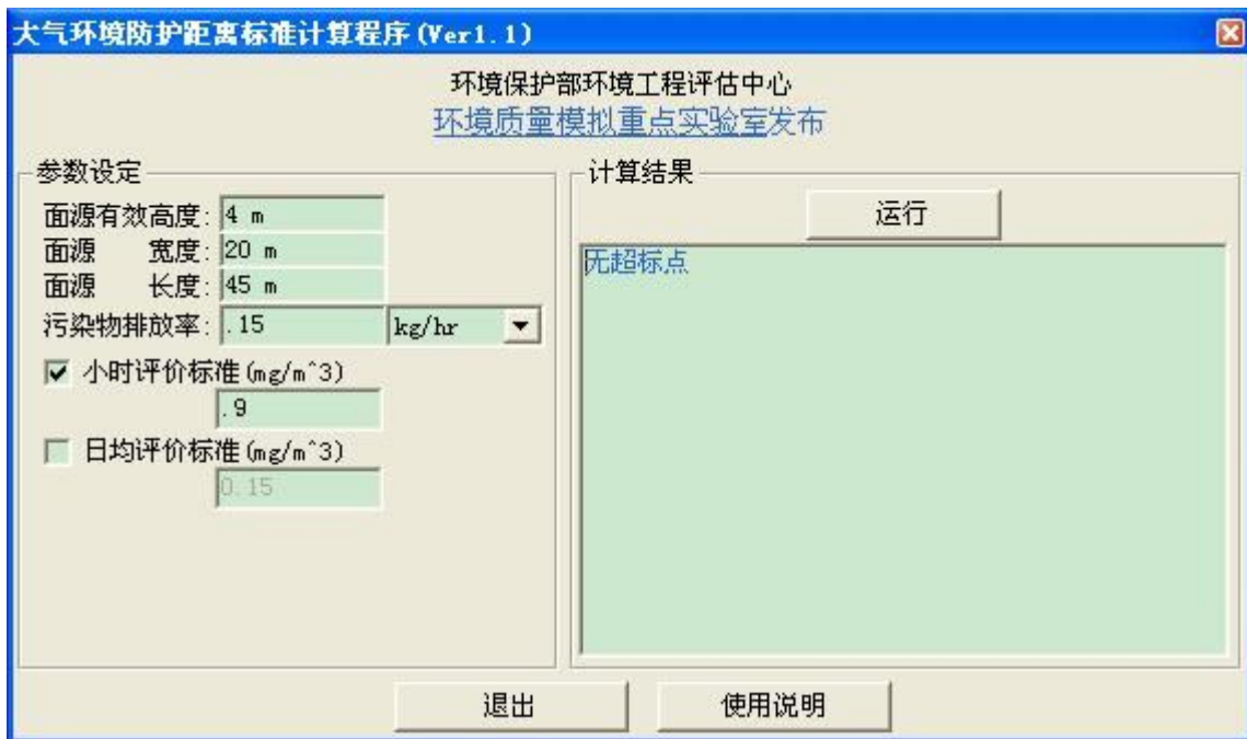
图 7-1 无组织粉尘大气防护距离计算结果图
